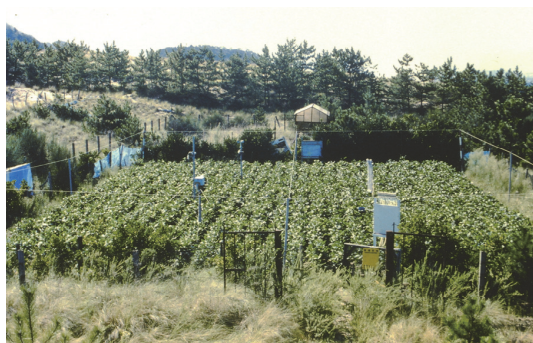
第7図 ウェイニングライシメータによる蒸発散量の測定 (昭和48年)
