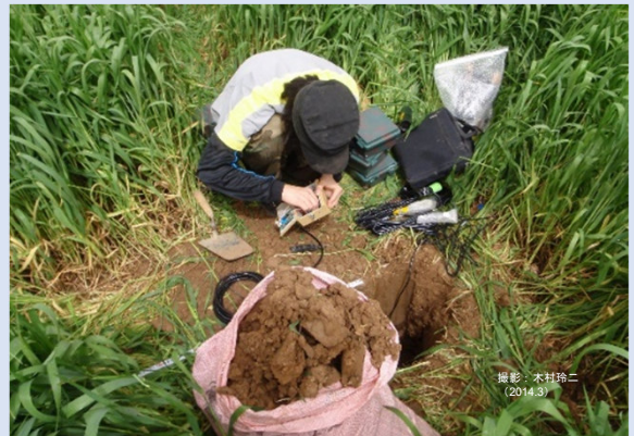
ダハラオアシスのコムギ圃場において土壌水分の鉛直プロファイルを観測するための土壌水分計を設置。
