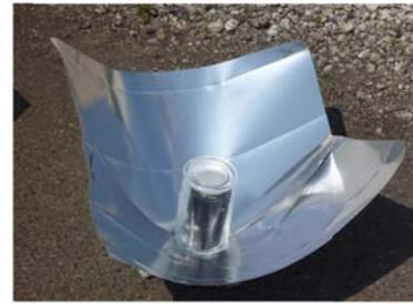
ソーラークッカーの機能は天気、とくに太陽の光の強さによって大きくかわります。よく晴れた日の鳥取の照度は、約100,000 luxです。
