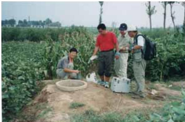
約80箇所の地下水位、水質を定期的に観測します。
