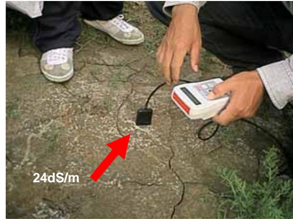
土壤間隙水の電気伝導度を測定して、農地における塩類集積状況を測定します。
