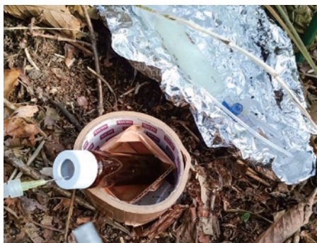
図2. 野外における根渗出物の調査 Fig. 2 Collection of root exudates in a field
