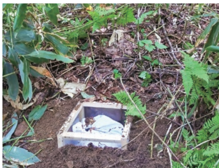
図1. 下層土壌の継続調査を行うために設置した根箱 Fig. 1 Root window box for continuous observation of subsoils
