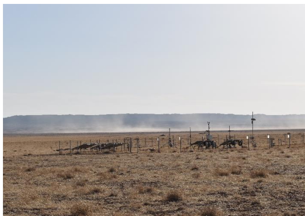
メインサイトの様子。最もダスト（黄砂）が発生する窪地は 水没する恐れがあるため、やや高めのところ設置。窪地で 頻繁にダストが発生している様子が見える。（2019年4月25 日 撮影：B. Buyantogtokh）
