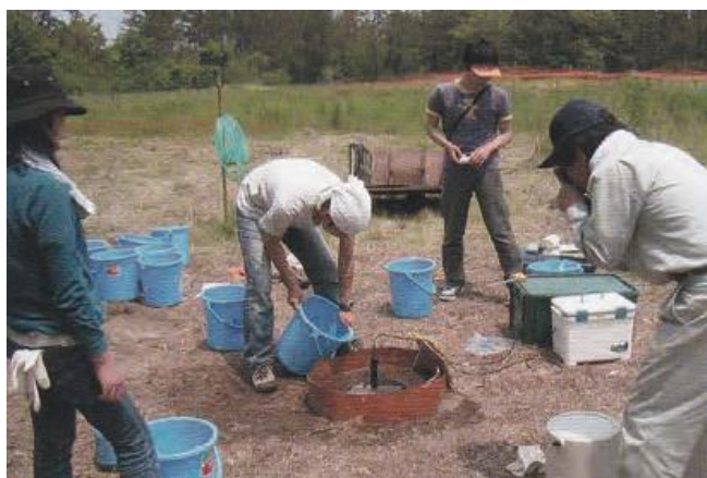
自由研究「ウェルパーミアメータを用いた 土壌深層部の透水性の測定に関する研究」 (2002年 提供:井上光弘[20周年誌より])
