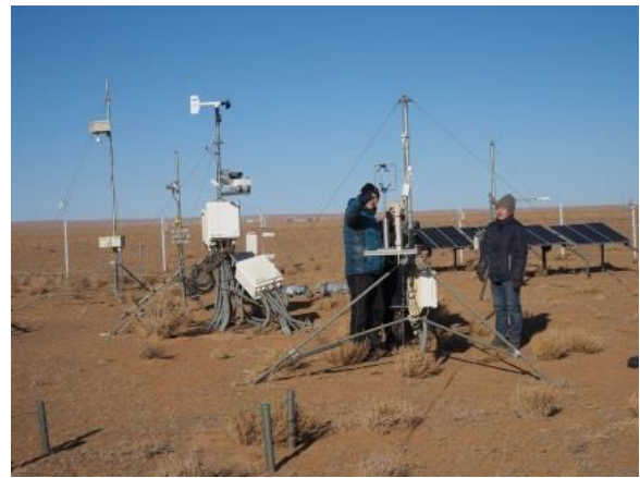
黄砂プロジェクトで、モンゴルのツォクトオボーに設置された観測機器類。これらを用いた黄砂の発生や気象の観測が続けられた。(2018年 撮影：山中典和)
