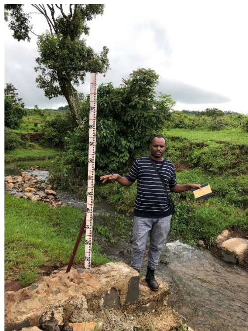
エチオピア SATREPS。アバガリマサイトの小流域で河川流量を測定している留学生 (Mulatu) (2019 年 8 月 5 日 提供：恒川篤史)
