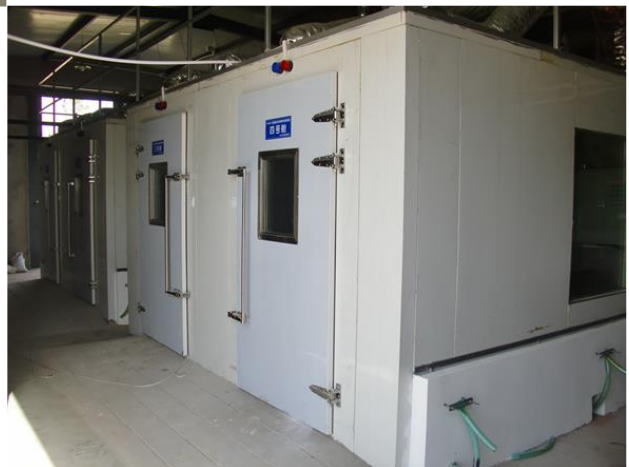
試験の一環としての呼吸量・成分測定のために牛を収容する 呼吸試験装置 (2015年5月7日 撮影：小林伸行)
