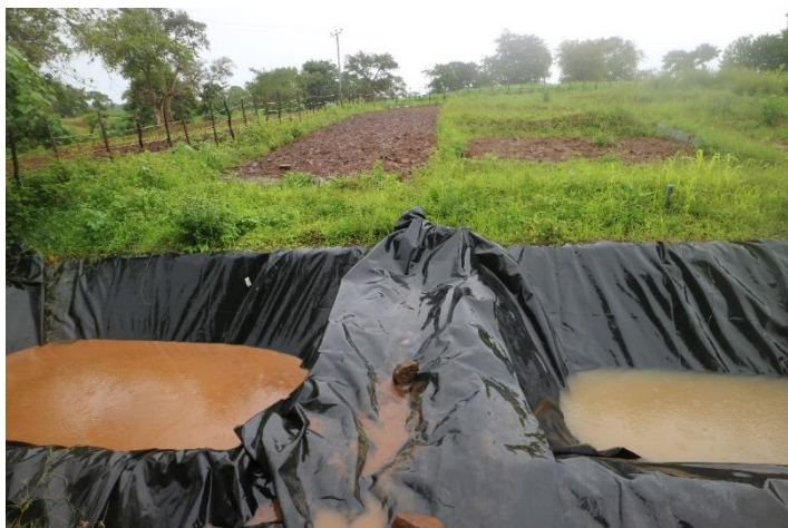
エチオピア SATREPS で実施しているプロット実験。左のプロット (対照区) に比べて保全策を講じた右のプロットでは流出水と土壌侵食量が少ない (2015 年 7 月 8 日 提供：恒川篤史)
