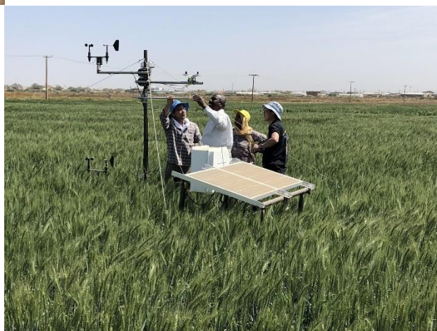
SATREPS において、ARC ワドメダニ本部に気象観測装置を設置し、坪充教授が農業生態系の微気象観測を開始（2020年2月26日 撮影：辻本壽）
