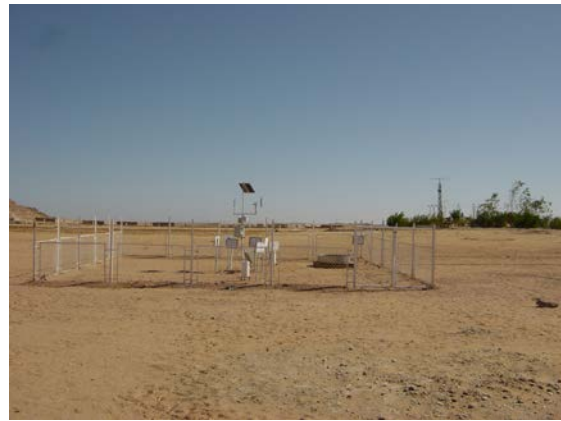
気象観測所。日射計の上部南側にソーラパネルが...
